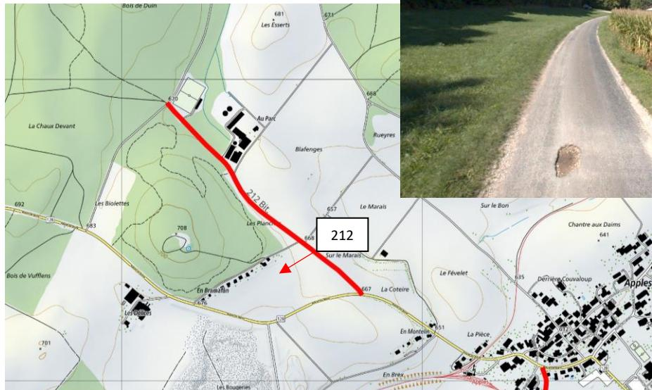
Le chemin 212 mesure 2.70 m de large sur 905 m de long et est revêtu de deux couches de gravillonnage.
