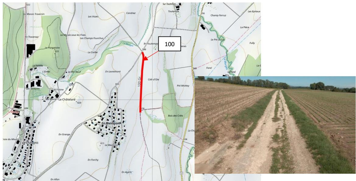
Le chemin 100 mesure 3.20 m de large sur 490 m de long et est en grave stabilisée.
